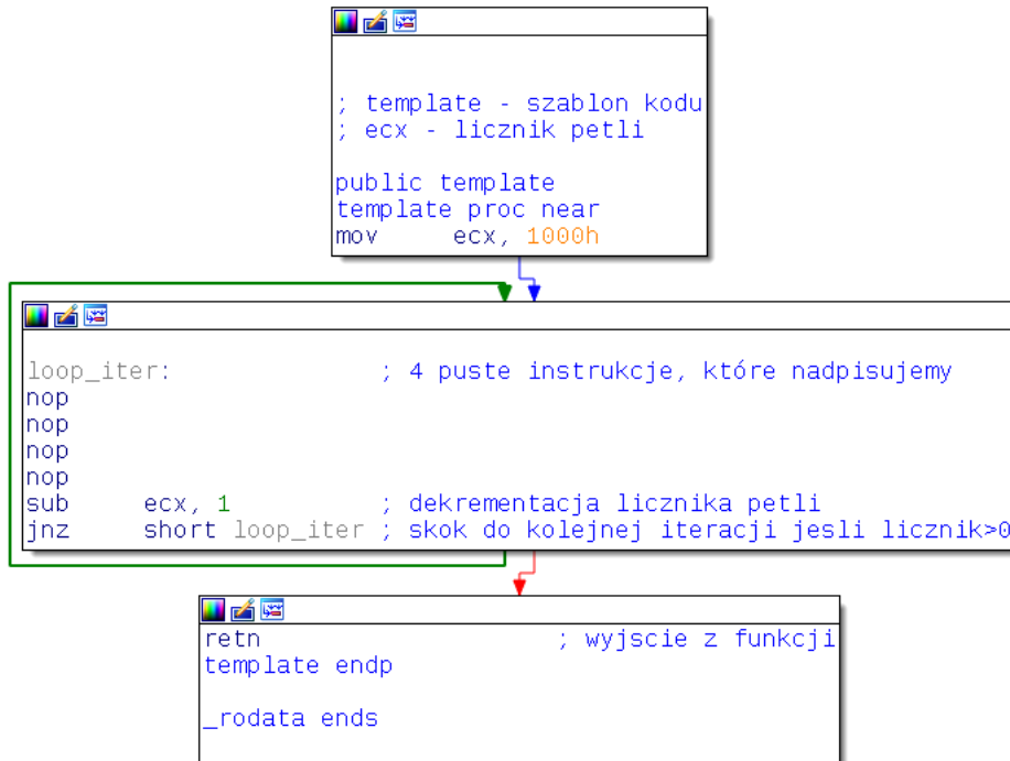
Rysunek 9.5. Szablon kodu, który jest kopiowany do zaalokowanej pamięci, w którym zmieniamy 4 bajty (instrukcje nop ).
